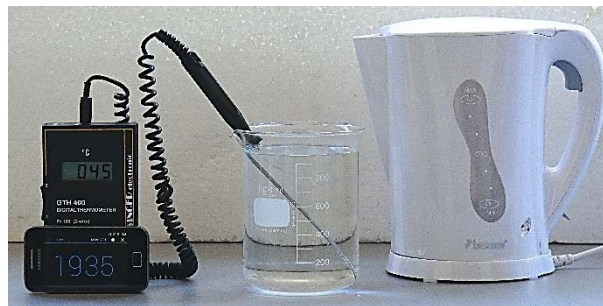
Abbildung 3: Abkühlungsprozess von Wasser: Die Anzeige links unten auf dem Smartphone zeigt die verstrichene Zeit in Sekunden an. Die Anzeige des Digitalthermometers darüber zeigt die aktuelle Wassertemperatur im Glasgefäß an.
